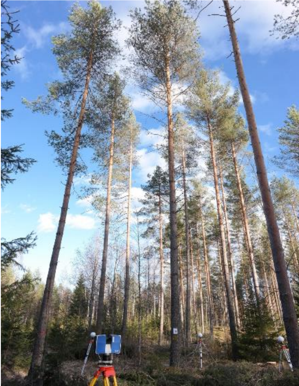
Kuva 4. TLS-mittaustilanne. Kuvassa näkyy maastolaserkeilain sekä mitattava, laputettu mänty keskellä. Referenssikohteina käytetyt pallot ympäröivät mitattavaa kohdetta. Kuva: Jiri Pyörälä.
