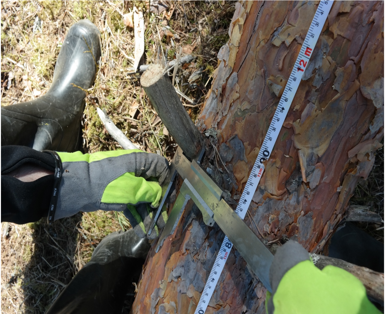
Kuva 5. Ulko-oksen läpimitan mittaustilanne. Työntömitalla mitattiin vaakasuoran läpimitan arvo millimetreinä. Runkoa vasten näkyy mittanauha ja korkeusarvo. Ulko-oksia on katkaistu mittauksien helpottamiseksi. Kuvan oksa on kuollut eli kuiva oksa. Kuva: Jiri Pyörälä
