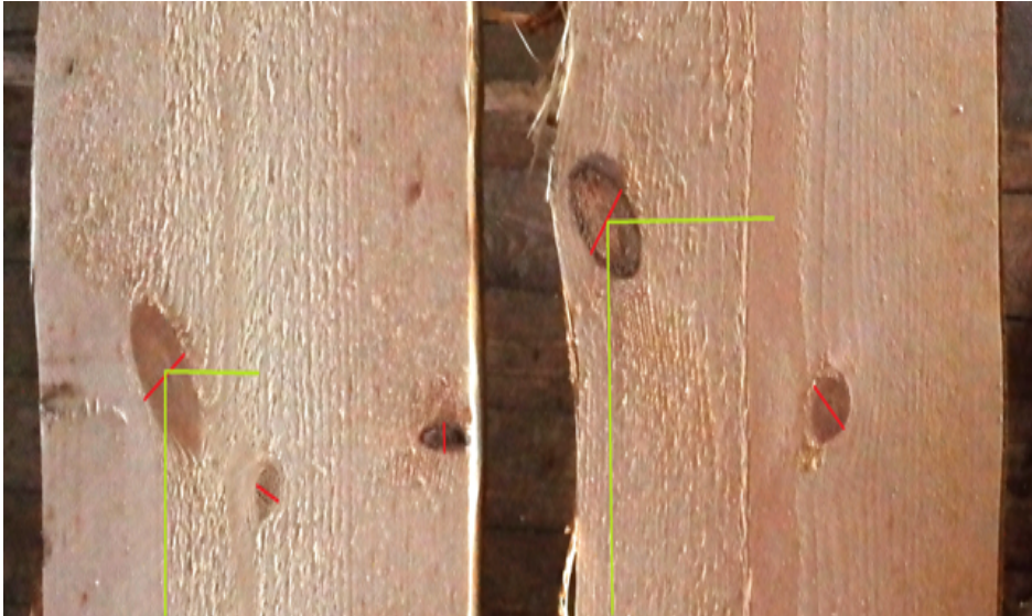
Kuva 7. Erikokoisia männyn oksia sahatavarassa. Oksan pienin läpimitta ja mittaussuunta merkattu kuvaan punaisella viivalla, Puun ydin näkyy sahatavaran keskellä. Kuvaan on merkitty myös oksan korkeuden ja etäisyyden mittaustapa keltaisella suorakulmalla. Kuva: Jiri Pyörälä
