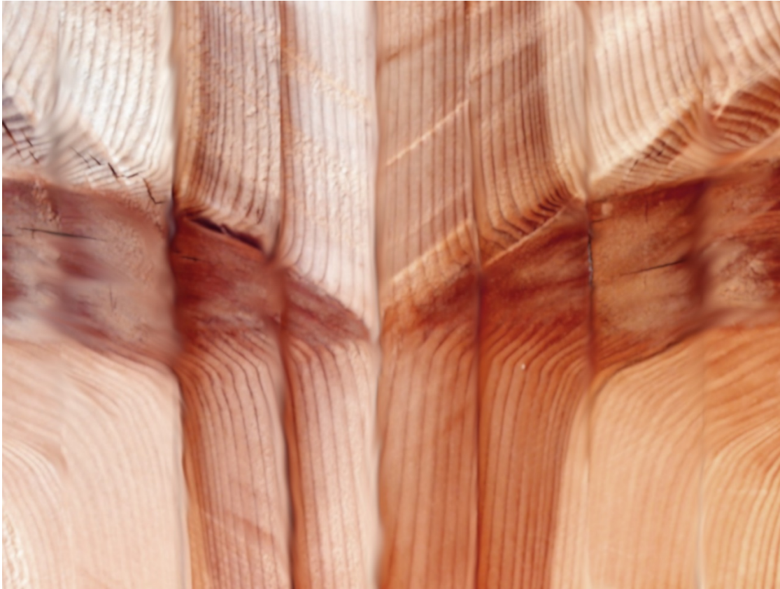
Kuva 2. Puuaineen käyttäytyminen männyn oksan ympärillä. Puun syyt taittuvat kasvusuuntansa vastaisesti oksan kohdalla. Poikkileikkaus sahatuista kappaleista.
