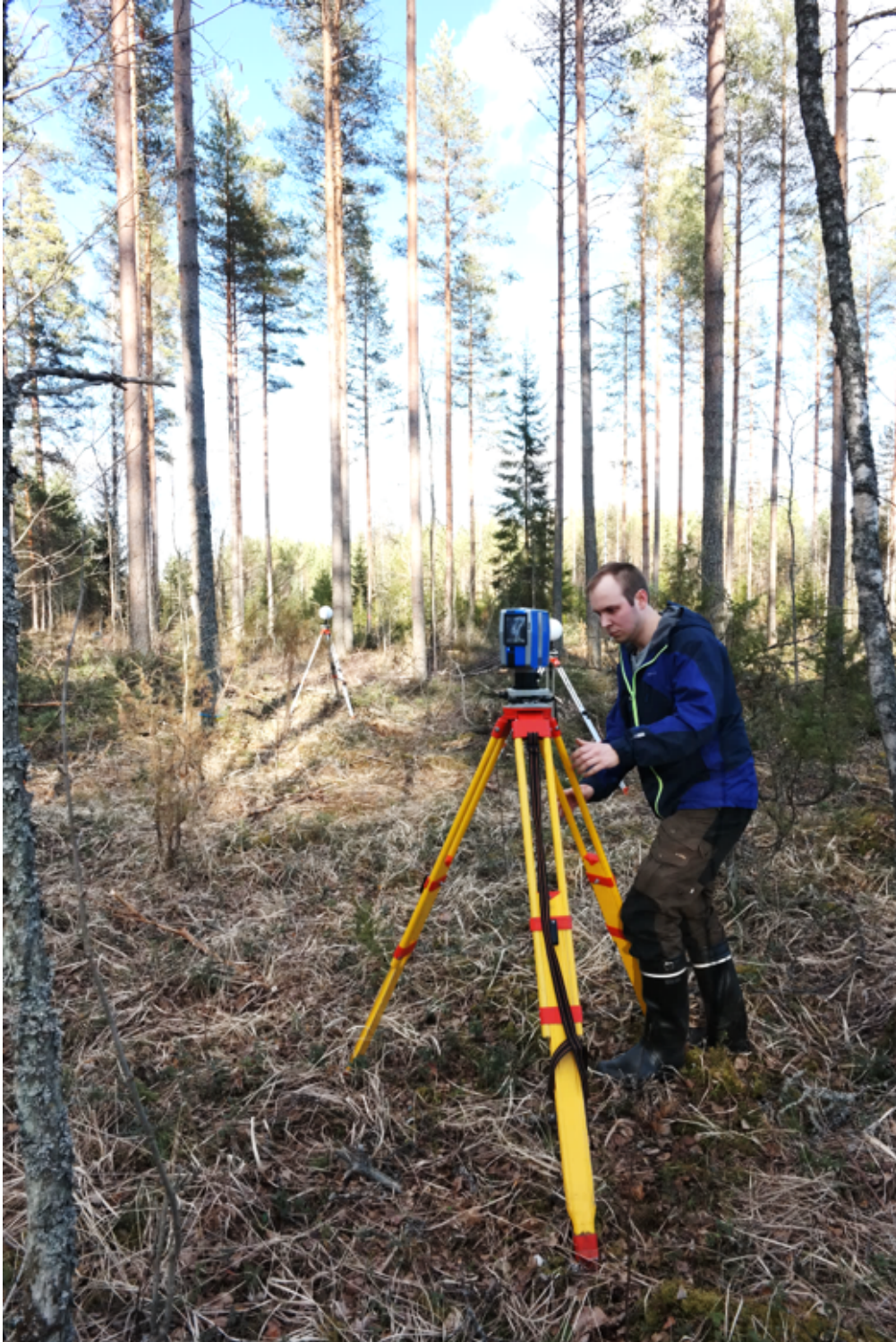
Kuva 3. Maastolaserkeilausmittauksen valmistelu. Maastolaserkeilaimen vakauttaminen kolmijalan päälle. Referenssikohteina käytetyt pallot näkyvät taustalla. Kuva: Jiri Pyörälä
