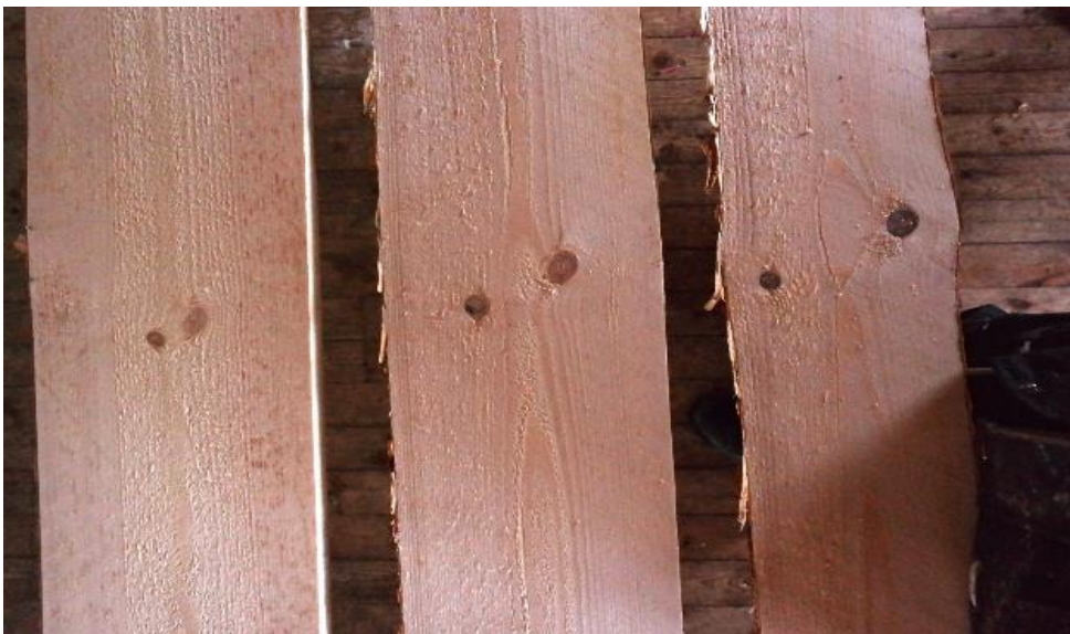
Kuva 8. Oksan kasvusta aiheutuva siirtymä puuaineessa. Kuvassa suunta ytimestä pintaan päin on katsottuna vasemmalta oikealle. Puun ydin näkyy sahatavaran keskellä. Kuva: Jiri Pyörälä
