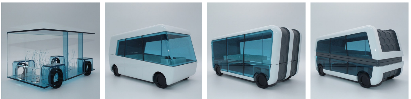
Abbildung 21: Maßkonzept-Modell (links) und drei verschiedene Design-Modelle (rechts); Quelle: eigene Darstellung
