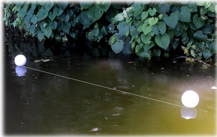
Figura 11. Medida de 4 m., hecho con bola de poliestireno expandido y lazo de nylon.
