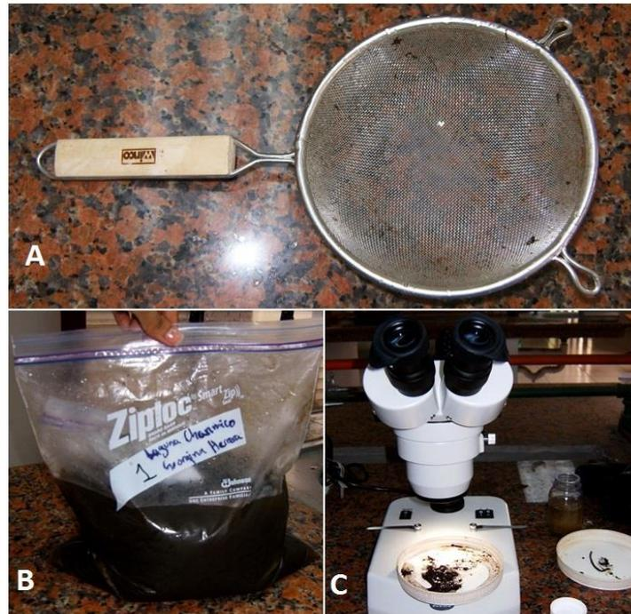
Figura 14. Equipo de laboratorio. A: Colador, B: Muestra de sustrato de fondo en bolsa con cierre hermético y C: Estereomicroscopio
