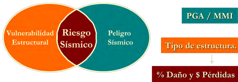
Figura 3.1. Evaluación del riesgo sísmico (tomado de Ventura, 2007)
