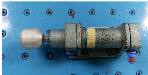
Fig.6: Cilindro de simple efecto del equipo del laboratorio de la Universidad de Cantabria
