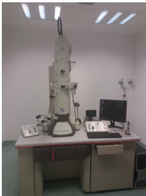
Figura 9. Microscopio electrónico de transmisión (TEM) JEOL del instituto de investigación Marqués de Valdecilla (IDIVAL).
