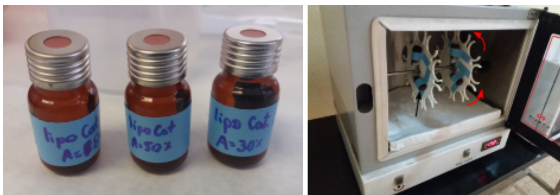
Figura 11. (izq.) Viales empleados en la síntesis de liposomas. (Der.) Horno de hibridación donde se colocaron los viales (flecha negra) para que estos giren con las aspás del horno (flechas rojas) y así se agiten los preparados y se sintetizen los liposomas.
