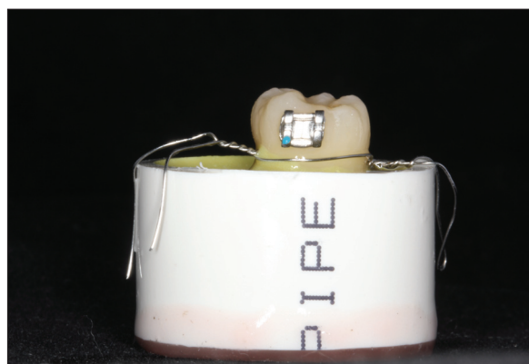
Fig. 2. Sample (tooth with bracket embedded in the acrylic block). Próbka (zęb z zamkiem zatopiony w akrylowym bloczku).
