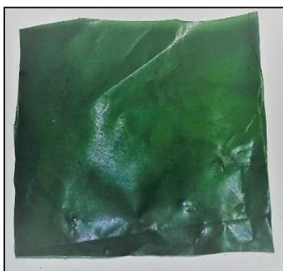
**Figura 13.** Fotografía de una película de PANI obtenida sobre sustrato de polietileno.
