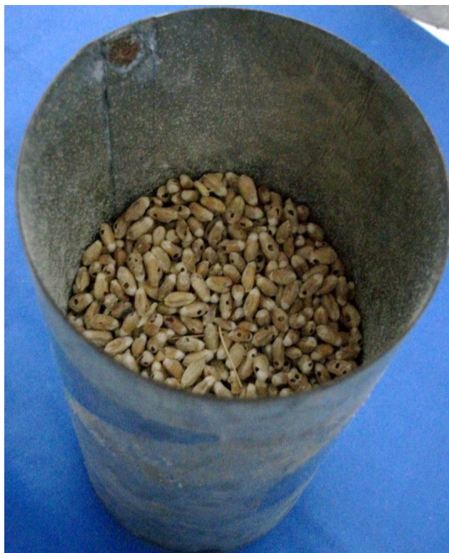
Figura 25. Recipiente cilíndrico de hierro galvanizado (silo), utilizado en los bioensayos. Medidas: 1mm de espesor por 7 cm de diámetro y 12 cm de altura. Capacidad: 400 ml.
