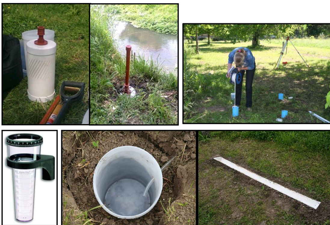
Fig. 4: Coletores para la toma de muestras de la escorrentía subsuperficial y el agua subterránea (arriba) y pluviómetro y colector de escorrentía superficial (abajo).
