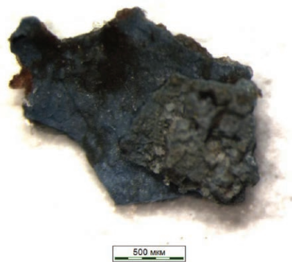
Рис. 3. Микрофотография постороннего включения, обнаруженного в консервах «Свекла столовая маринованная»
