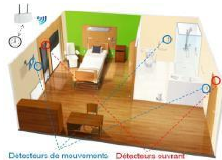
Figure 2 : Équipement domotique prévu initialement dans chaque chambre des résidents, et installé par Schneider.
