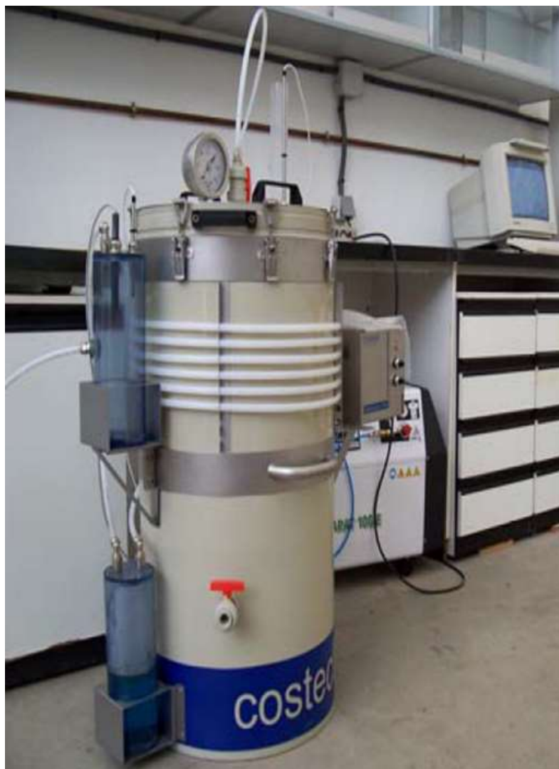
Figura 3.3.1. Respirómetro dinámico en fase sólida. (Respirómetro 3022)
