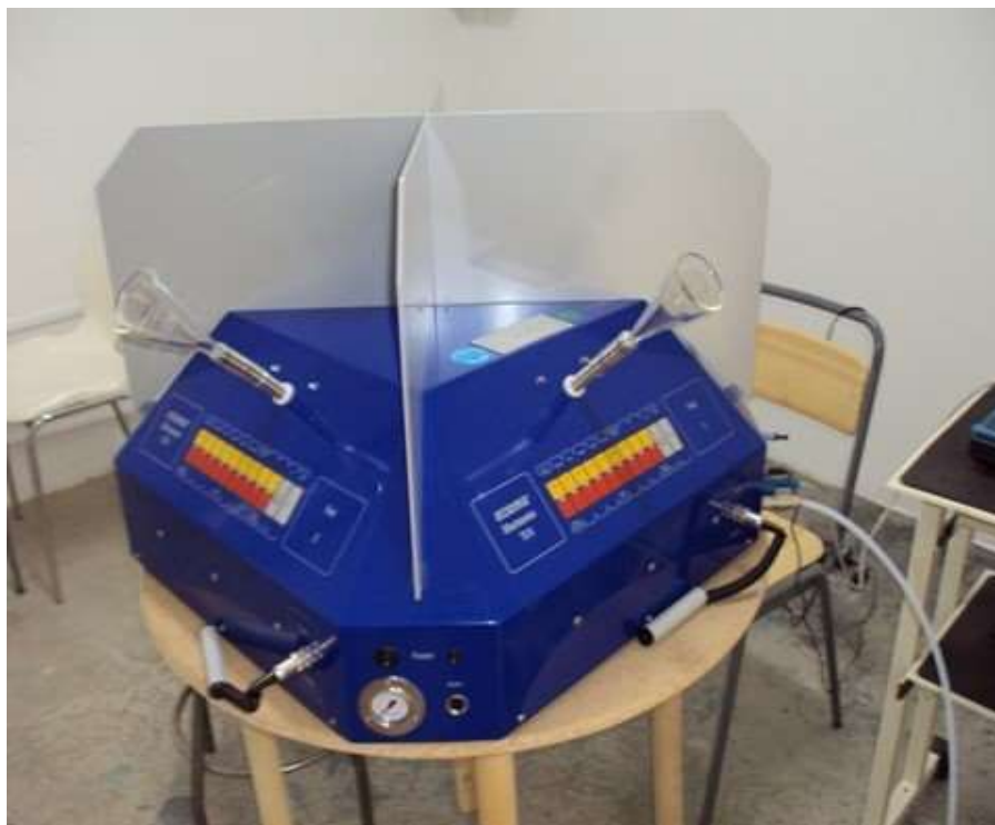
Figura 3.4.1. Olfatómetro dinámico. (Olfatómetro T08 de TO-Series)
