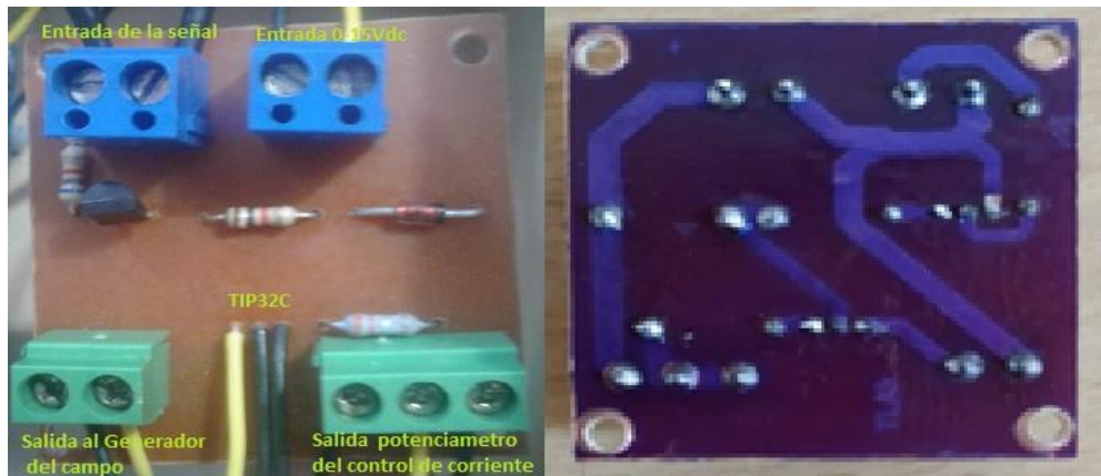
Figura 3.9. Tarjeta de potencia y acoplamiento con montaje de los elementos necesarios.
