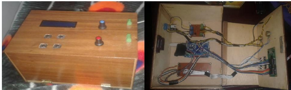
Estructura principal y montaje de los bloques de control, acoplamiento y módulo de transistores. Elaborado por: John Almache, Edwin Andrango.
