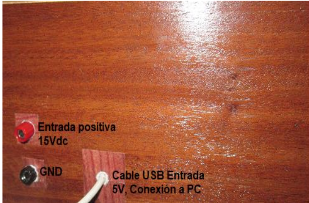
Figura I.2. Conectores de la parte posterior del prototipo Elaborado por: John Almache, Edwin Andrango.
