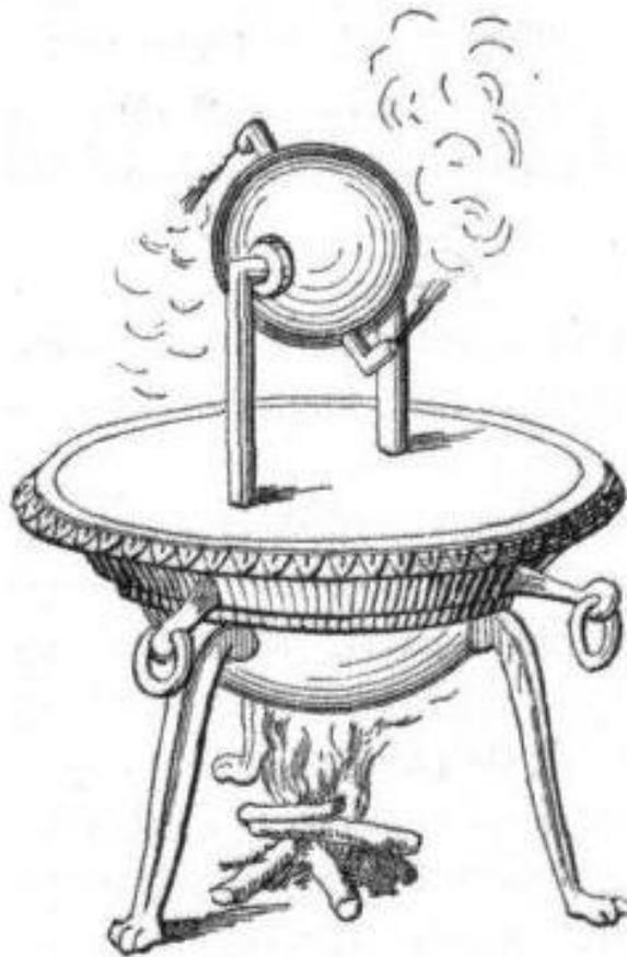
Figura 1.1 - Eolípila, a primeira turbomáquina.[10]
