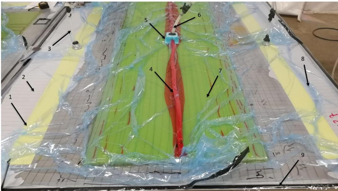
Figura 3.4 - Método de Infusão de Resina; 1) Rede impermeável á resina; 2) PEEL PLY®; 3) Mangueira de vácuo; 4) Tubo espiral de infusão; 5) Caixa de infusão; 6) Mangueira de injeção de resina; 7) Placa de PVC e fibras; 8) Saco de vácuo; 9) Tacky Tape®
