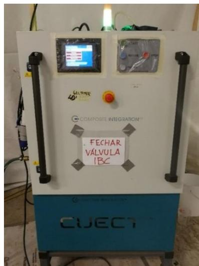
Figura 3.5 - Equipamento de mistura de resina
