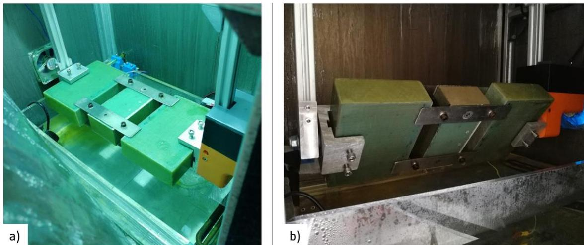
Figura 4.7 – Ciclos do ensaio de envelhecimento: a) Ciclo de radiação UV onde os provetes se encontram paralelos à fonte de radiação, na horizontal; b) Ciclo de condensação onde os provetes rodam para um ângulo de aproximadamente de 60 ° com a tina
