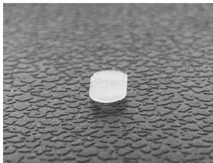
Figura 4.2: Modelo cilíndrico construído por molde utilizado nos ensaios de compressão
