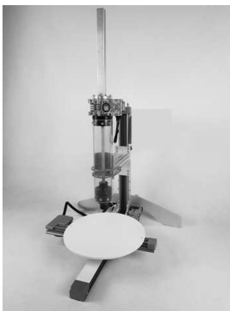
Figura 4.5: Impressora 3D - 3D Potter, Micro8 (retirado de [97])
