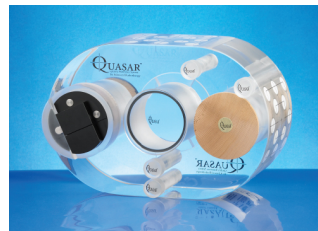
(b) Modus QA QUASAR™ thorax phantom.
