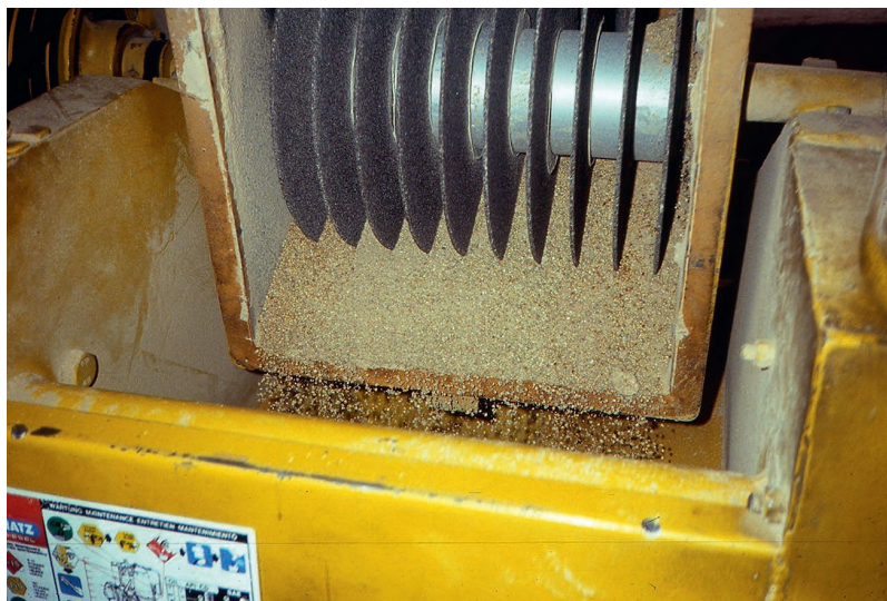
Photo 16. Chambre de décortiquage avec disques abrasifs (© Jean-François Cruz, Cirad).
