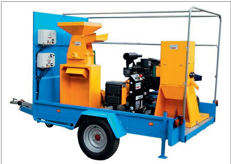
Photo 18. Module mobile avec décortiqueur et broyeur (© document Electra).
