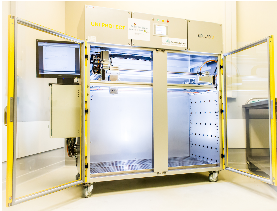
Abbildung 3a: Fotografie eines Prototypen des Infrarotthermographiesystems. Dieses basiert auf einem in der Tierversuchshaltung üblichen Haltungsschrank. Er besitzt eine einstellbare Lüftungs- und Beleuchtungseinheit sowie verschiedene Funktionen zum Überwachen und Dokumentieren der Haltungsbedingungen.
