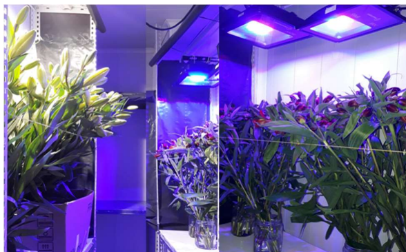
Figura 1. Tratamientos con iluminación. Las irradiancias se ajustaron con la distancia de las fuentes de luz a las varas florales. / Figure 1. Light treatments. The irradiancias were set by adjusting the distance between the flowers and the light sources.
