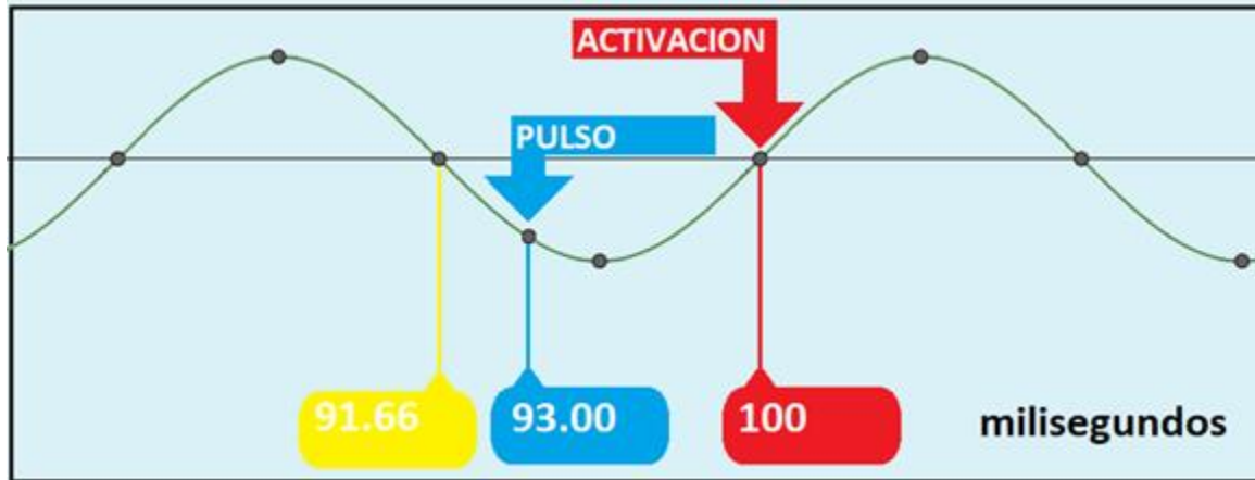
Figura 4. 31 Velocidad de respuesta del programa con las SSR.
