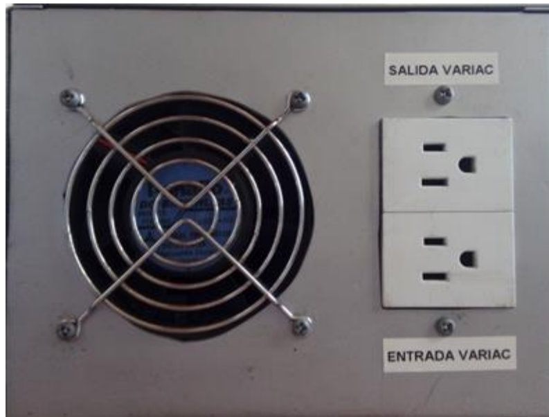
Figura 3. 5 Vista lateral izquierda del generador de sags
