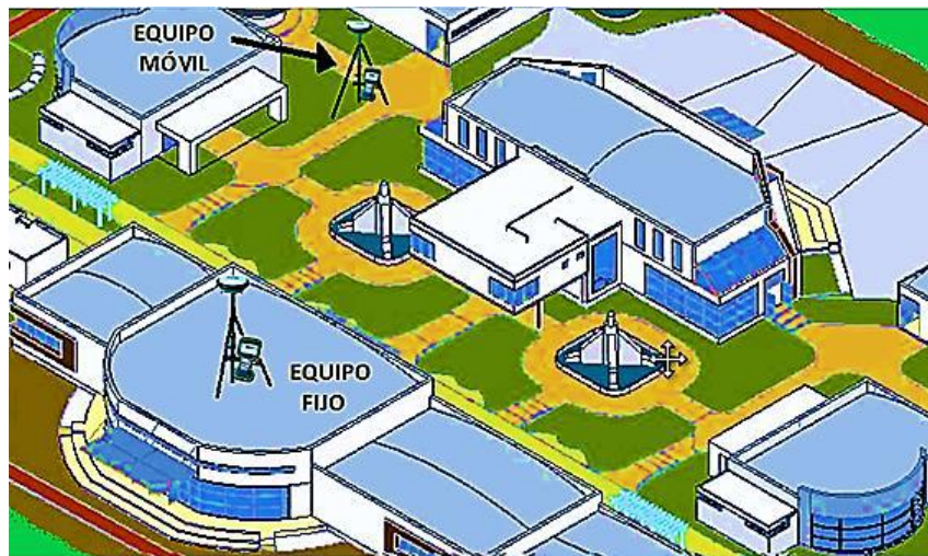
Figura 2. 6: Ubicación recomendada para receptor Base y Móvil en técnica RTK.
