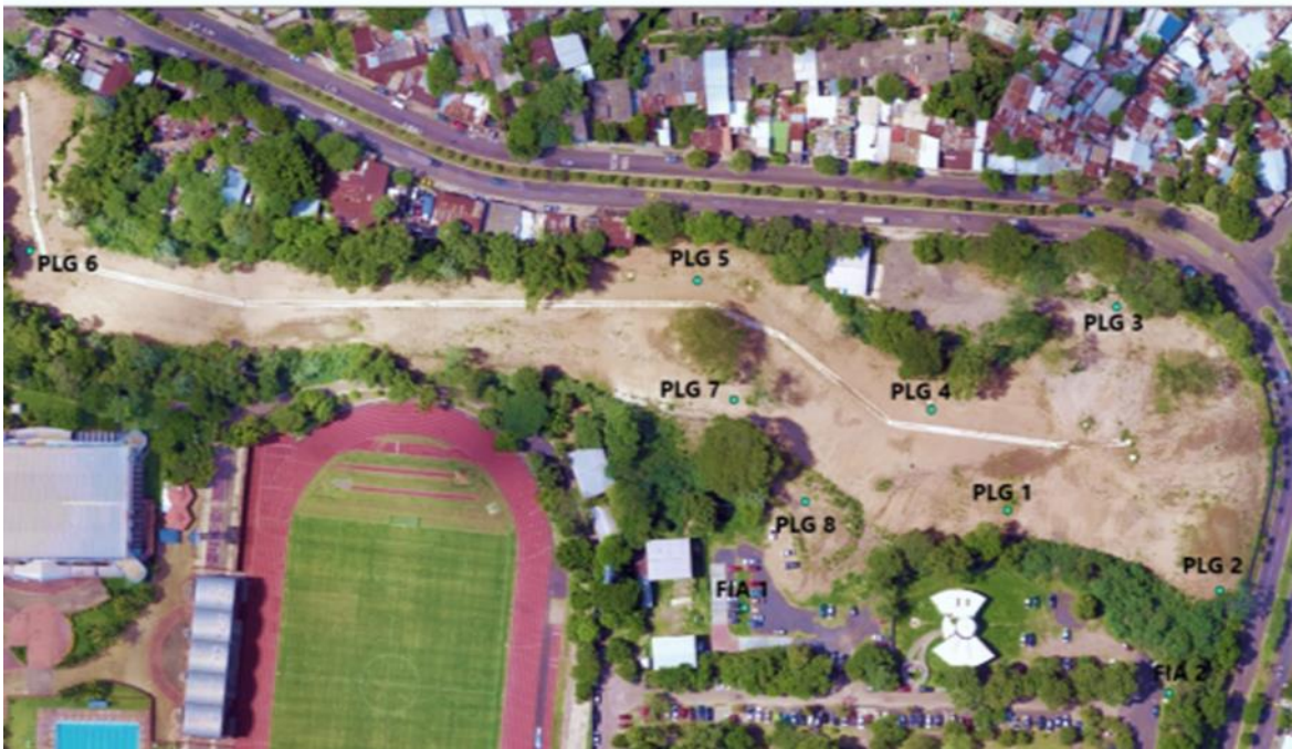
Figura 4.6: Puntos de poligonal ubicados por medio de la fotogrametría con el uso del dron. Fuente: Propia
