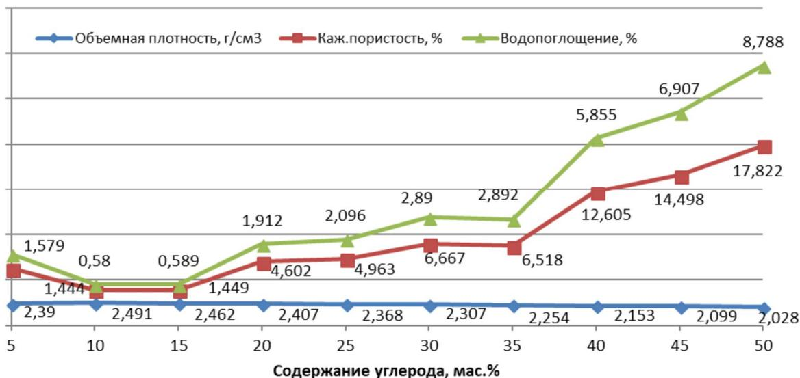
Рис. 2. Зависимость свойств синтезированных материалов от содержания графита.
