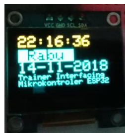
Gambar 11. Percobaan dengan LCD dan RTC
