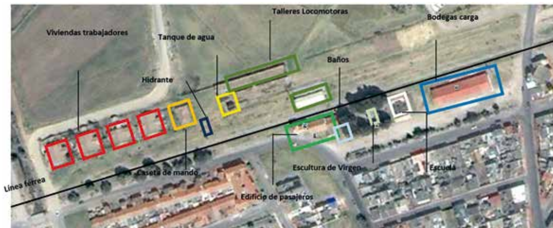
Figura 3. Componentes del sistema ferroviario estación de Sogamoso-Boyacá.
