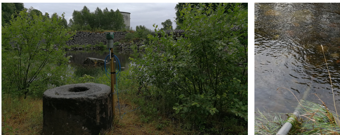
Figur 3. Plassering av automatisk måleutstyr for vannkvalitet i dam i Farriselva. Logger på stolpe og sensor i foringsrør.
