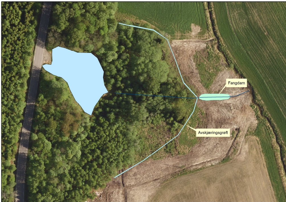
Figur 24. Skisse av snødeponiet og fangdam med avskjæringsgrøft.
