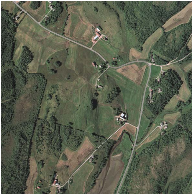
Bilde 3: Kartet er et resultat av flyfotografering, fulgt av fotogrammetrisk konstruksjon og tolking av flybildet. 3Q-kartene inneholder informasjon om arealer, linjeelementer og punktobjekter og danner grunnlaget for beregning av indikatorer.
