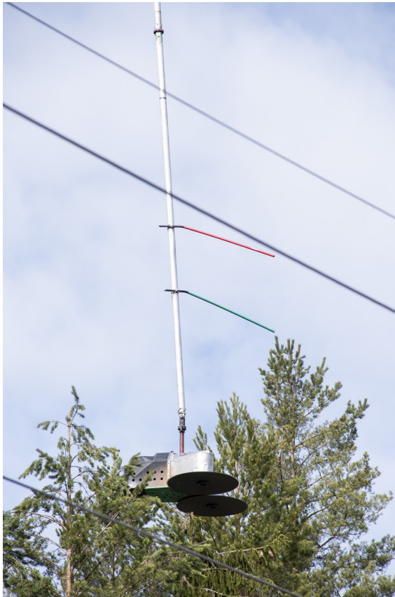
Til helikoptertopping benyttes en tobladet toppsag, det vil si en rigg med to horisontale blader montert i trekant i samme høyde. Fargede merkepinner på staget hjelper piloten med å toppe i riktig høyde. Foto: Lars Sandved Dalen, NIBIO.
