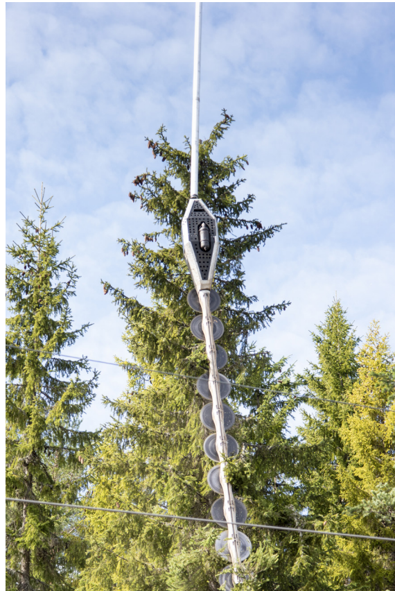
Til helikopterkvisting benyttes en rigg på omkring sju meter med sju til ti blader hengende under hverandre. Foto: Lars Sandved Dalen, NIBIO.
