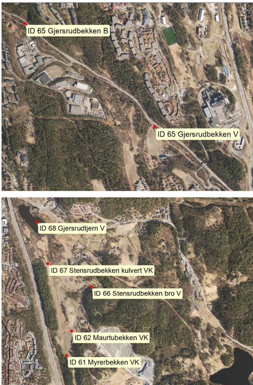
Figur 1. Overvåkingstasjoner rundt anleggsområdet på Åsland for kontinuerlig overvåking og/eller vannprøvetaking og fisk- og bunndyrundersøker. V=vannprøver. K= Kontinuerlige målinger. B= Biologiske undersøkelser.
