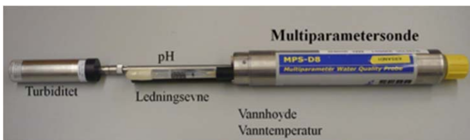
Figur 7. Multiparametersonde (MPS-D8) som er benyttet på stasjonene for kontinuerlige automatiske målinger.
