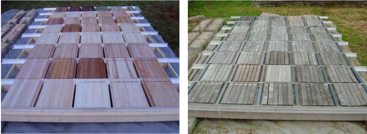
Figur 4. Norske løv- og bartrær i over bakke testing på Fana ved Bergen, et samarbeidsprosjekt mellom Skog og landskap og NTI. Vi ser at etter ett års eksponering er mange av fargeforskjellene mellom treslagene borte. Foto: Per Otto Flæte.
