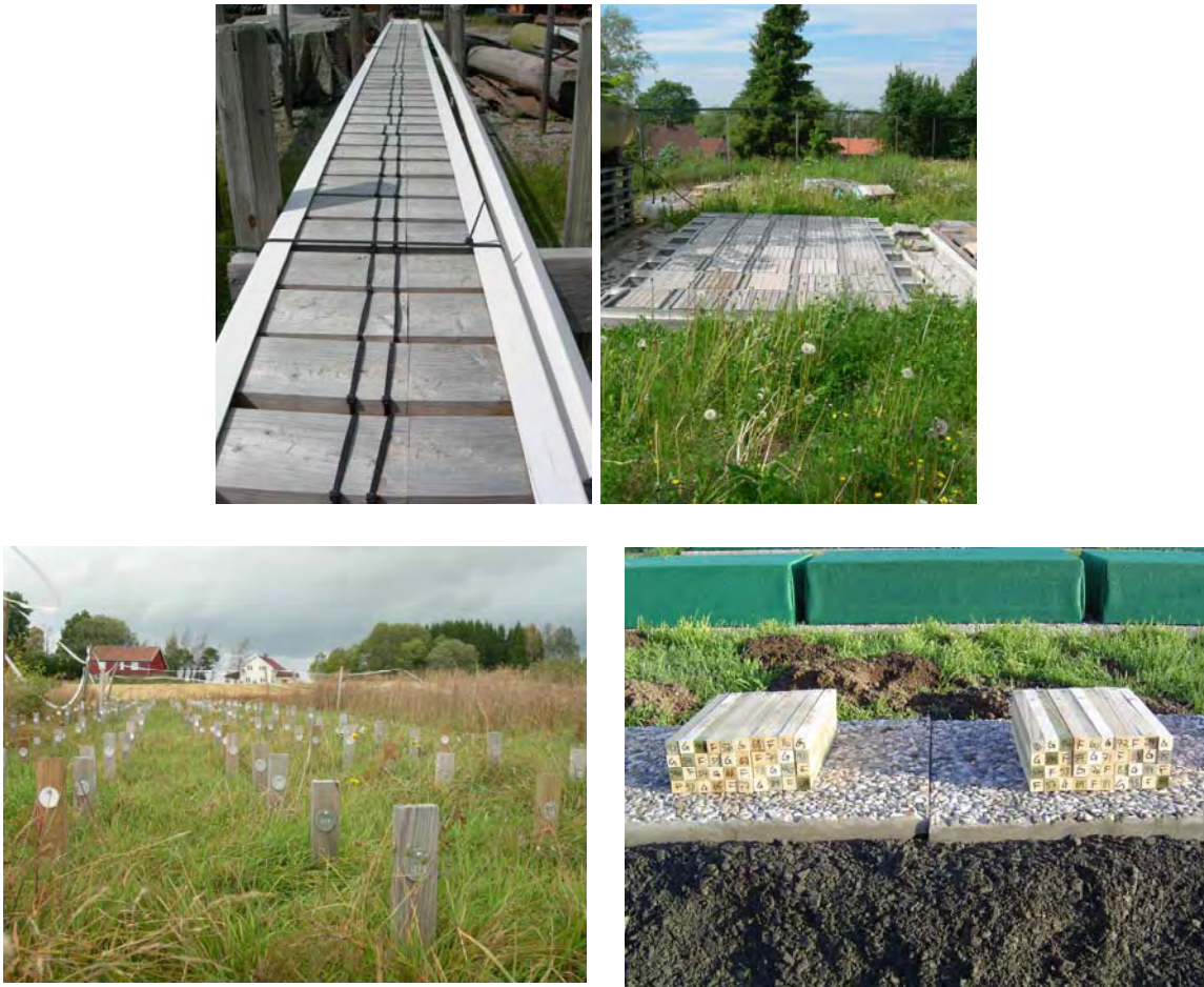
Figur 6. Ulike felttestmetoder. Lap-joint, double layer, EN 252 og blocktest. Foto: Gry Alfredsen.
