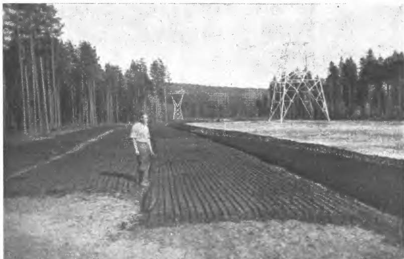
Fig. 5. Utlagt torv på tørkefeltet, som i dette tilfelle består av planert fastmark, fin sand. (Fra Pukerudmyra brenntorvanlegg, Sokna. Fot. Aa. L.).
