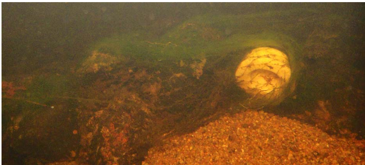
Figur 3. DGT passiv prøvetaker som ligger i strømpenettet sitt tjoret til en stein fra elvbunnen. Begroing er et problem for DGT'er. De bør heller ikke ligge ute for lenge. Funksjonen til membranene er temperaturavhengig, så i varmt vann bør de ligge i kortere perioder. Ved temperatur under 10 grader kan de ligge ute i inntil to måneder.
