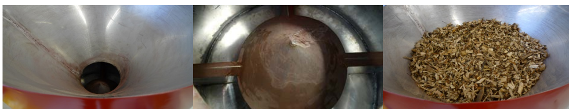
Figur 4. Flisdeler som deler flisprøven i fire deler. Etter deling såldes tre av prøvene.
