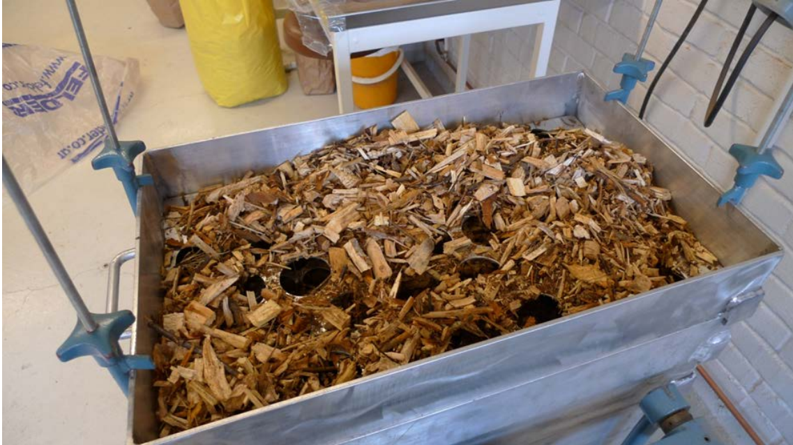
Figur 5. Flis ble fordelt på det horisontale såldeapparatet og såldet i 15 minutter.
