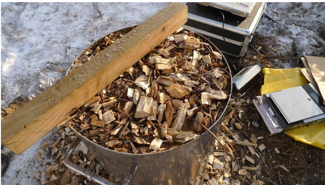
Figur 2. Bestemmelse av bulkdensitet ved veiing av beholder med kjent volum.
