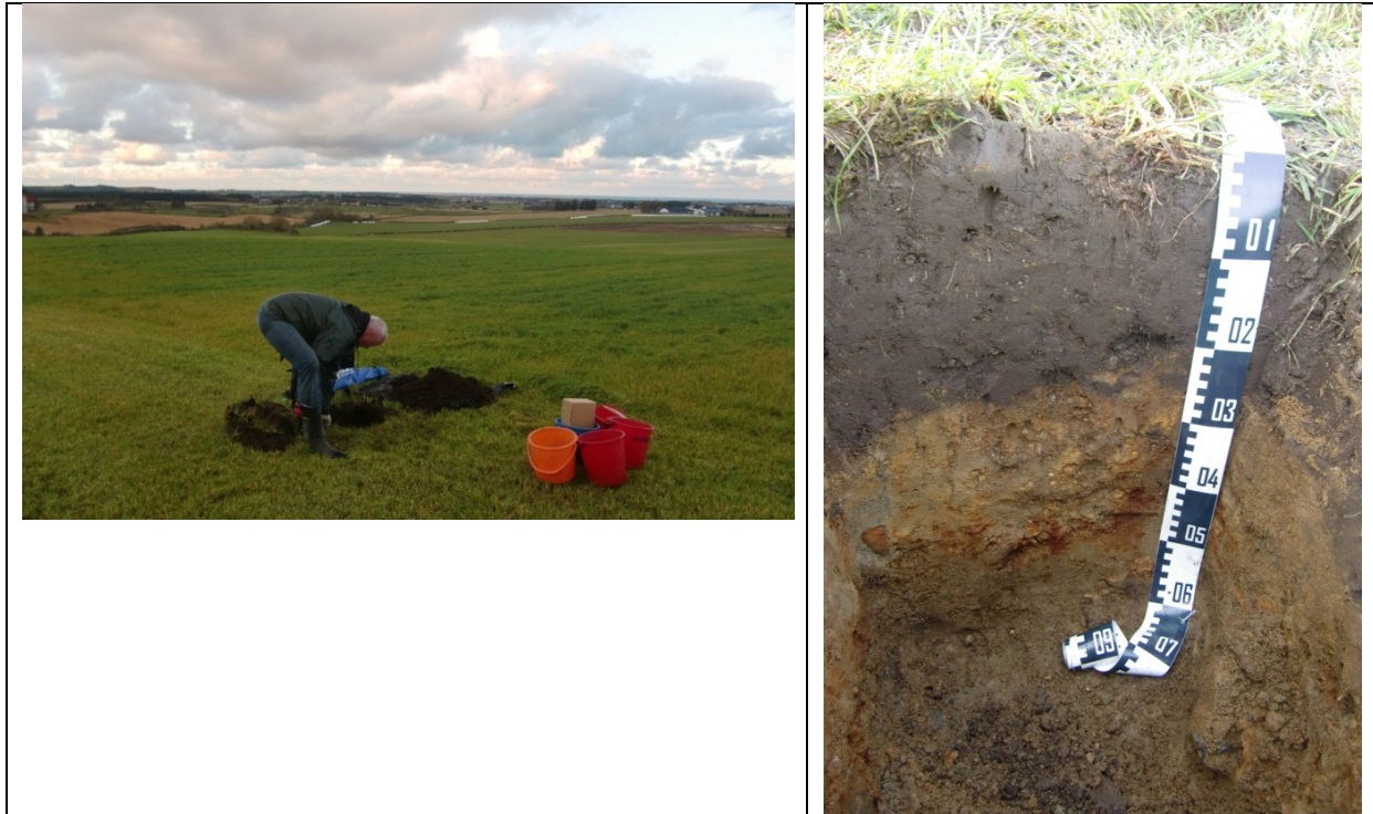
Figur 3.10. Arbeid med prøvetaking av jordprofil på Jæren og jordprofil nr.3
