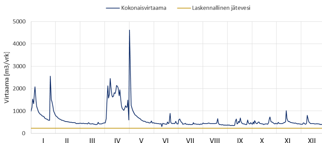
Kuva 18. Sahansuon pumppaamon virtaamat sekä laskennallinen jäteveden määrä.
