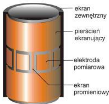
Rys. 2. Schemat jednopłaszczyznowego czujnika ECT
