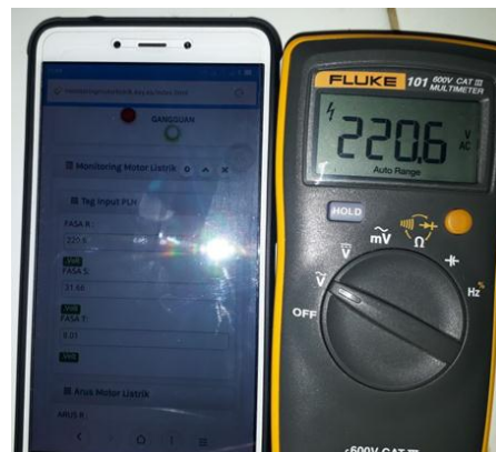
Gambar 1 Pengujian sensor tegangan ZMPT101B
