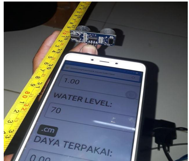
Gambar 4 Pengujian Sensor Ultrasonik HCSR04
