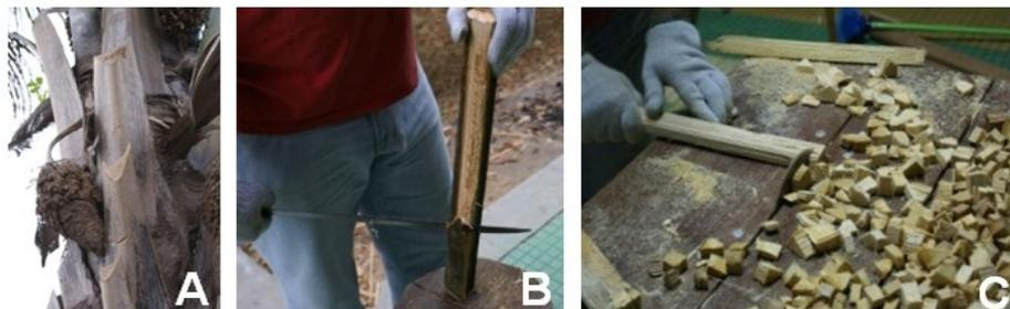
Figura 03. Beneficiamento do pecíolo de inajá. Detalhe dos pecíolos extraídos (A); Remoção da Epiderme (B); Produção de Cavacos (C).
