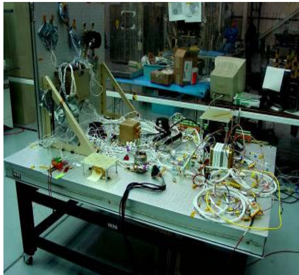
Figure 21. TacSat-2 FlatSat Testbed
