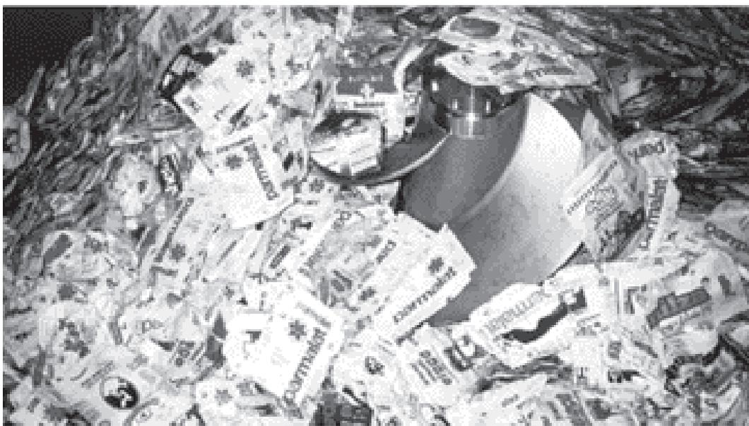
Figura 02: Hidrapulper em alta consistência antes da desagregação
