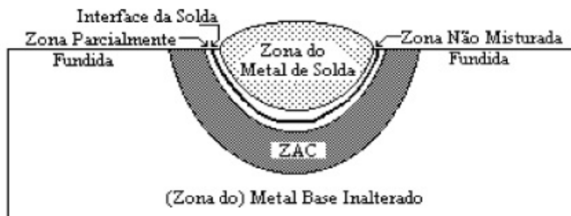
Figura 2 – Zonas da junta soldada.
