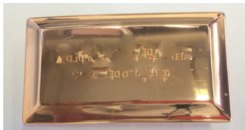
Figura 3 – Peça de zamac eletrodepositada com camada de cobre alcalino.
