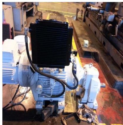
Gambar 4.2 Penambahan oil cooler pada speed variator
