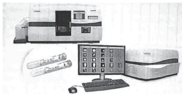
Рис. 1. Напівавтоматична система CELLSEARCH, що може захоплювати та підраховувати кількість ЦПК [4]
