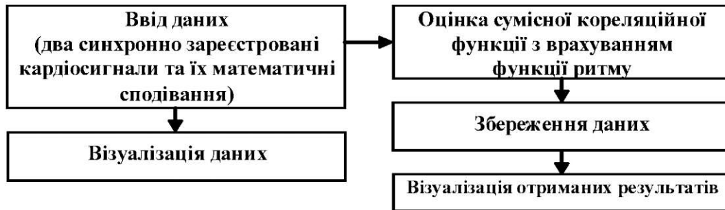
Рис. 5. Структурно-функціональна схема модуля програми «Сумісна статистична обробка СЗБС».
