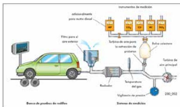
**Figura 5.** Esquema de pruebas dinámicas
