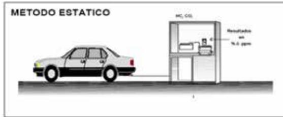
**Figura 1.** Esquema de prueba estática
