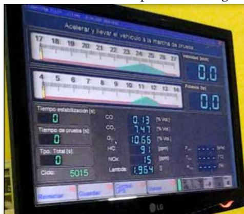
**Figura 6.** Software para ciclo ASM
