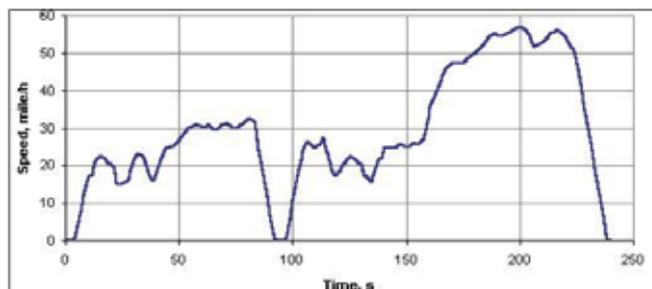
Figura 8. Esquema de velocidad vs tiempo del ciclo IM 240
