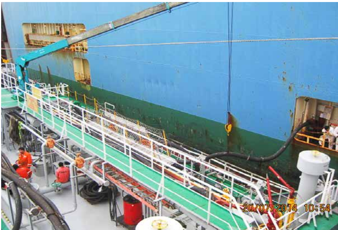
Figura 4. Conexión de manguera para el abastecimiento de combustible necesario Fuente: CORPETROLSA S.A. Elaboración: Autor
