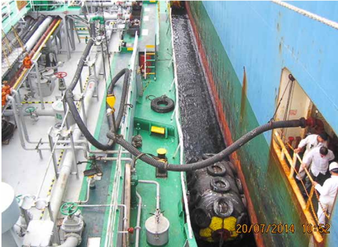
Figura 5. Maniobra en la que se define posición de la toma y el tipo de combustible Fuente: CORPETROLSA S.A. Elaboración: Autor
