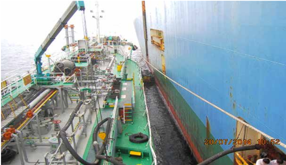
Figura 3. Buque abarloado, pasando el respectivo combustible Fuente: CORPETROLSA S.A. Elaboración: Autor
