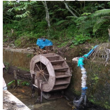
Gambar 1. Pemanfaatan kincir air untuk memutar generator untuk menggerakkan pompa
